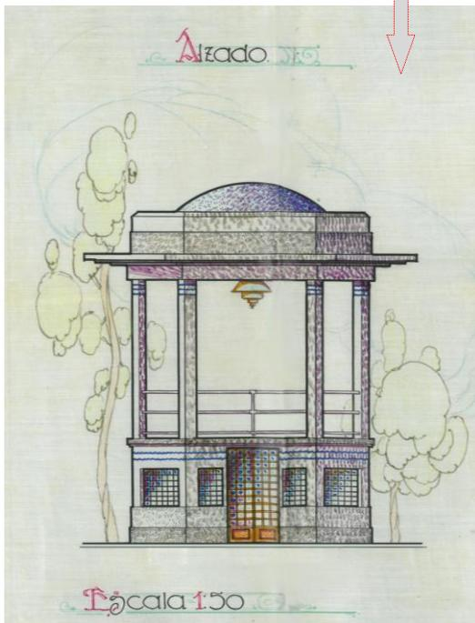
Arriba: plano original del proyecto diseñado, en agosto de 1930, por el aparejador José L. Martín. Consta de las dos plantas, el alzado, la sección (ampliada a la izquierda con restauración de líneas) y el emplazamiento. Escala 1 : 50.
